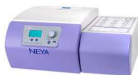
Centrifugadora PROFESIONAL REFRIGERADA NEYA 10R, 4x175 ml, 6000rpm, 10 Programas
